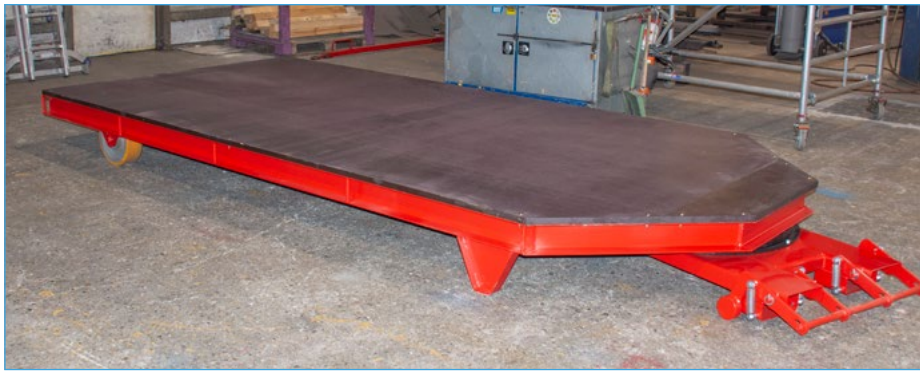
STS mit rutschhemmenden Betosiebplatten
