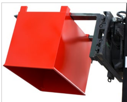
Entleerung durch Stapler mit Drehgerät
