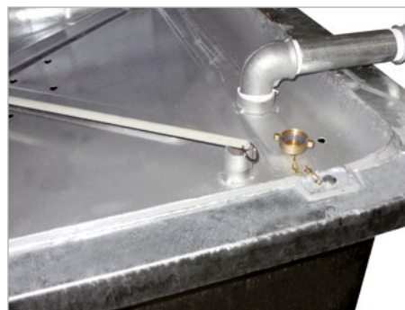
Peilstab zur Füllstandskontrolle
