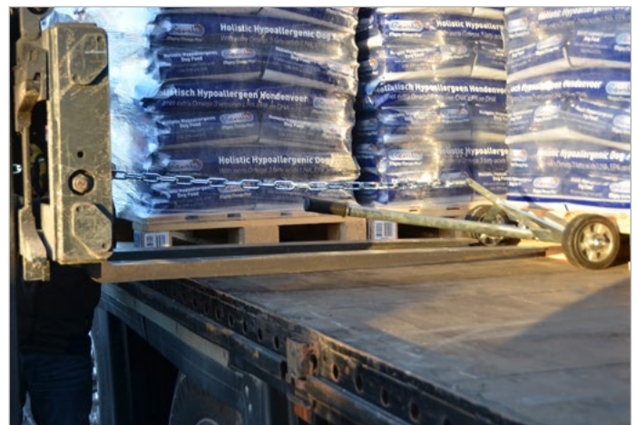
Heranziehen der Palette mittels Gabelstapler in die „Erste Reihe“
