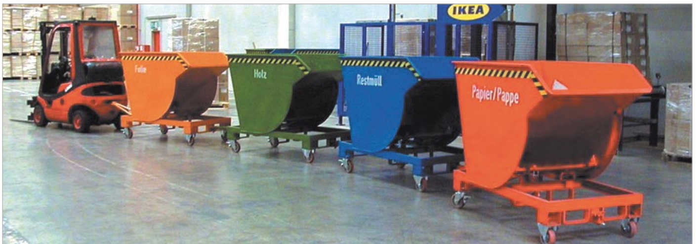
BKM mit Rollen und Anhängervorrichtung mit Deichsel
