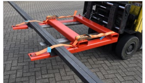
Aufnahmeposition zum Be- und Entladen
