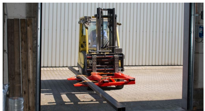
Einfaches Passieren durch Tore und Gänge beim Transport von Langgutmaterial mit dem LSL
