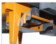
Bolzensicherung am Gabelstapler
